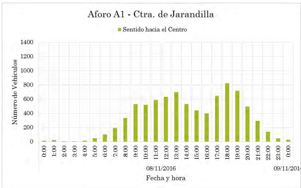
Figura 55. Resultados del aforo automático de 24 h realizado en la Ctra. de Jarandilla (Aforo-A1). Sentido hacia el centro de Navalmoral de la Mata.
